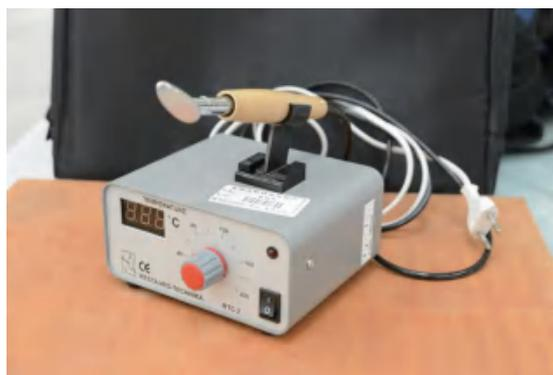
图 6 精确控温电热抹刀
