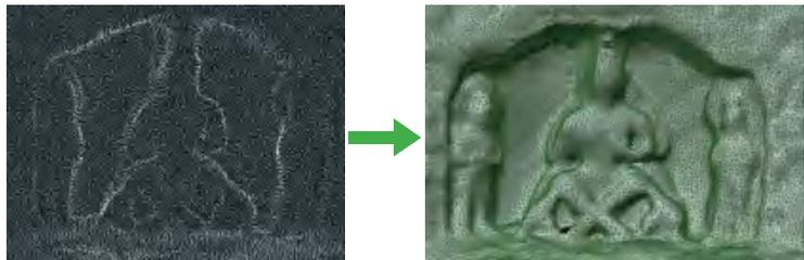
图 7 原始点云数据构建三角网模型
