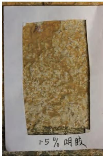
图 4 颜料层粉化加固后
