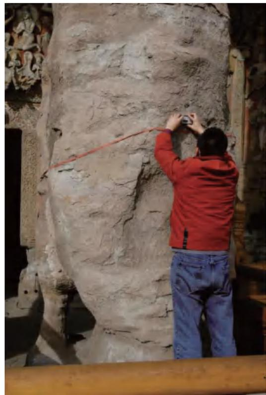
图8 云冈第9、10窟东列柱风化程度环境磁学无损测试现场
