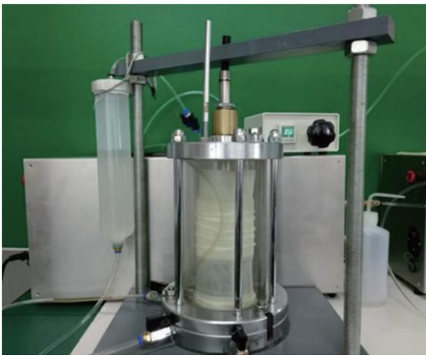
图 4 柔性壁渗透仪
